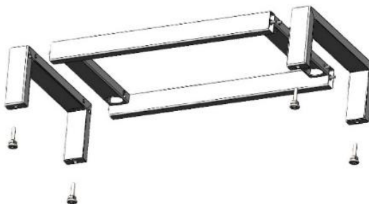
Рис. 1. Сборка высокого каркаса
